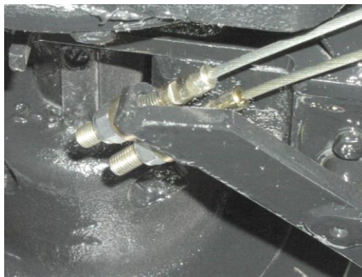
brzdový klíč, uložení provozní a parkovací brzdy
