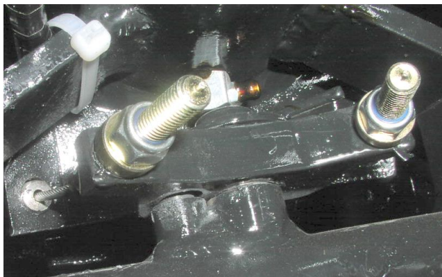
vahadlo pod převodovkou, lanka na jednotlivá kola
