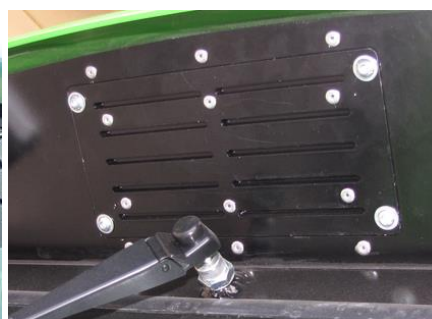
Pro přístup k filtru je nutné vyšroubovat 4 šrouby
