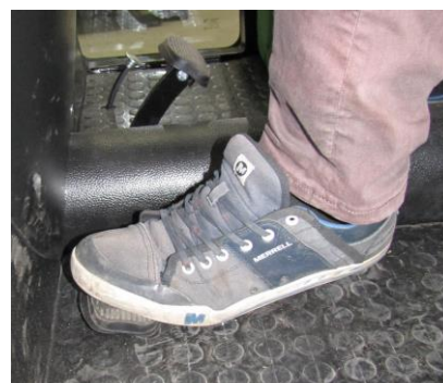
Plné vyšlápnutí spojky – úplné přerušení točivého momentu
