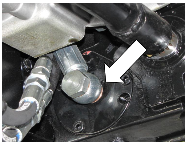
hydraulický filtr – mění se vložená patrona
