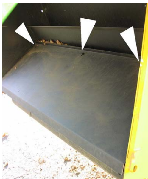
šipky vyznačují matky upevňující odklápěcí desku
