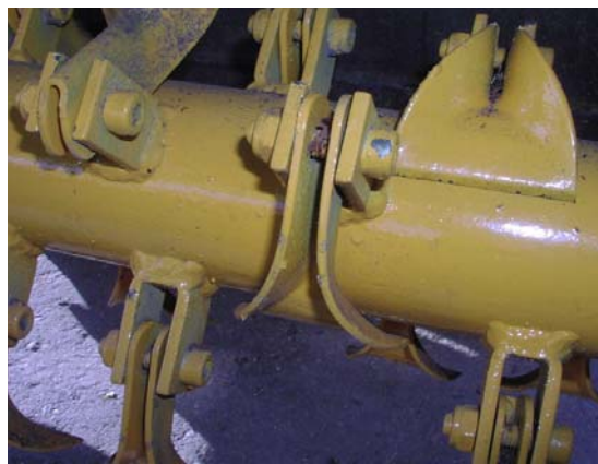
detail uložení nože (kladiva)
